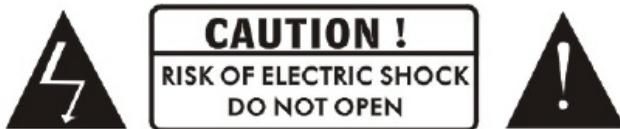
23. Dieses Blitz Symbol innerhalb eines Dreiecks soll die Benutzer darauf hinweisen, daß innerhalb des Gerätes eine Spannung entsteht die hoch genug sein kann um einen Elektro-Schock herbeizurufen. Warnung: Um Elektro-Schocks zu vermeiden sollten Sie die Abdeckungen des Geräts nicht entfernen, und den Service nur dem Fachpersonal überlassen. Das Ausrufezeichen deutet darauf hin, dass es zu diesem Gerät weitere Hinweise im Handbuch gibt.
